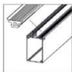
11. Zijligger 1 x afdichtingsrubber
